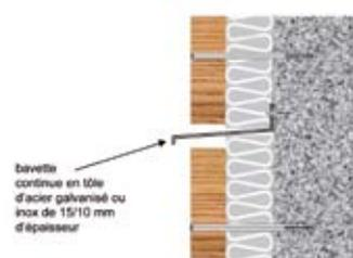
Exemple de recouvrement de la lame d'air dans le cas d'une mise en œuvre en ERP
